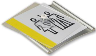
Textwechsel: Haftsauger in der Schildmitte ansaugen. Plexiglas abheben. Texteinleger wechseln. Plexiglas mit Haftsauger in eine seitliche Nut einlegen und in die gegenüberliegende Seite einstülpen. Achtung - Die antireflektierende Seite muss vorne sein.
