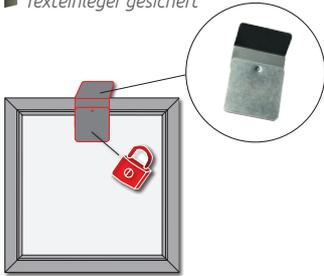
Der Einlegerwechsel erfolgt durch nach oben oder seitlichen schieben des Profilrahmens mit dem Daumen in Richtung des Wechselements. Texteinleger auswechseln und Abdeckglas in die Führung wieder einschieben bis die Sicherung einrastet.
