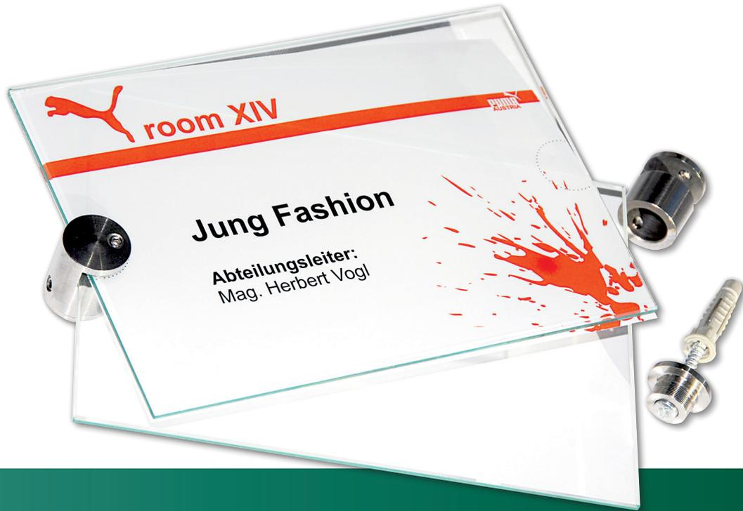
*Textwechsel: Schrauben am Glashalter vorne lösen. Gläser herausnehmen. Texteinleger wechseln. Glasscheiben im Glashalter einrichten. Schraube vorne wieder festziehen.*
