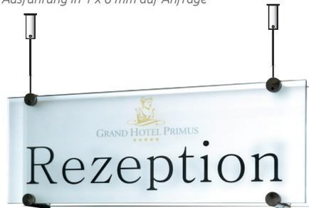
Montage mit 1,5 mm Stahlseilen und iNOX Edelstahldeckenhalter d1.s. Zur beidseitigen Beschriftung wird der iNOX Halter hb.s mit 30 mm Abstand zwischen den 2 x 4 mm ESG Scheiben eingesetzt.
