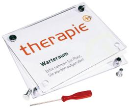
*Textwechsel: Die Inbusschraube am INOX-Abstandhalter lockern. Abdeckkappe herausziehen. Die obere Scheibe abheben Texteinleger wechseln. Abdeckkappe einstecken und Inbusschraube festziehen.*
